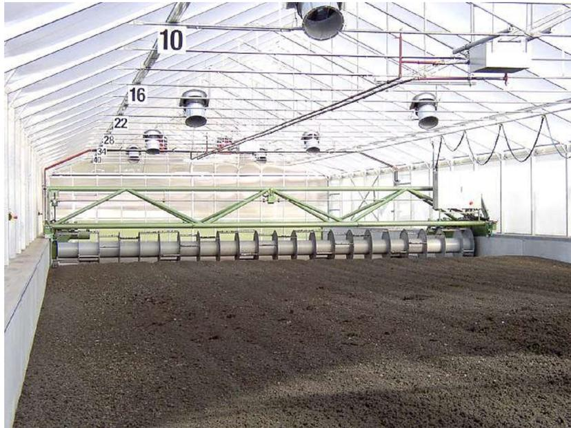
Abbildung 5: Solare Klärschlamm-trocknung nach dem Durchlaufverfahren. In der Bildmitte der Wendewolf®
